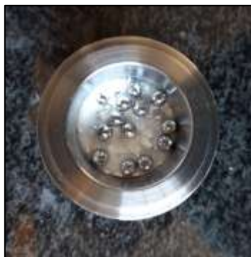
Figura 13. Vaso de molienda con bolas y mezcla de reacción.
