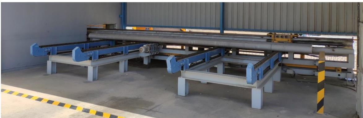
Fig. 24. Tochos de aluminio en la boca de entrada de la prensa.
