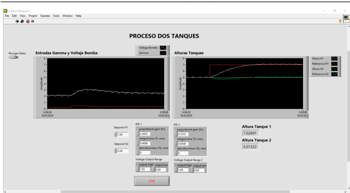
Figura 39. HMI Proceso Dos Tanques LabVIEW
