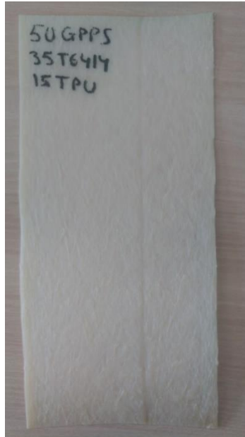
Fig. 35: lámina de 50% GPPS + 35% SBS T6414 + 15% TPU
