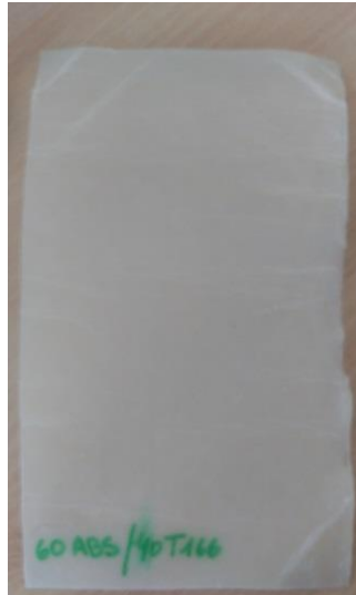
Fig. 39: lámina de 60% ABS + 40% SBS T166
