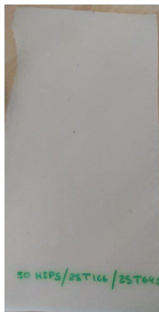
Fig. 42: lámina de 50% HIPS + 25% SBS T166 + 25% SBS T166
