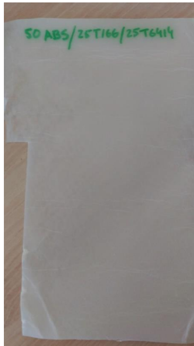
Fig. 41: lámina de 50% ABS + 25% SBS T166 + 25% SBS T6414
