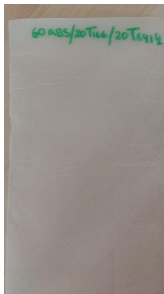
Fig. 40: lámina de 60% ABS + 20% SBS T166 + 20% SBS T6414
