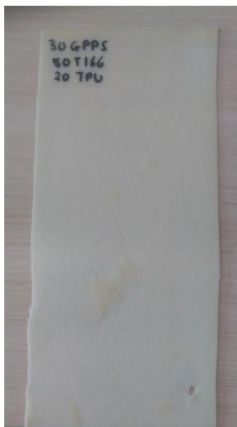
Fig. 36: lámina de 30% GPPS + 50% SBS T166 + 20% TPU
