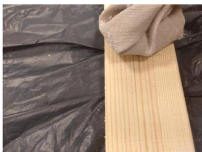
Figura 53. Encerado del bastidor.
