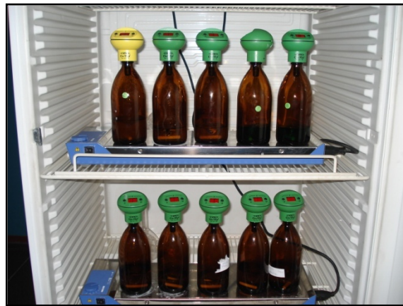
Fig 2.4.5. Equipo para la determinación de la Demanda Bioquímica de Oxígeno
