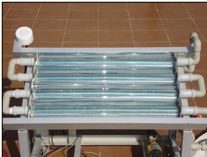
Fig. 2.2.2. Planta piloto de fotocatalisis solar de 4 L.
