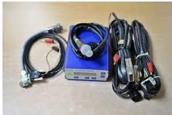
Ilustración 58. Equipo de medida de Lambda ETAS.
