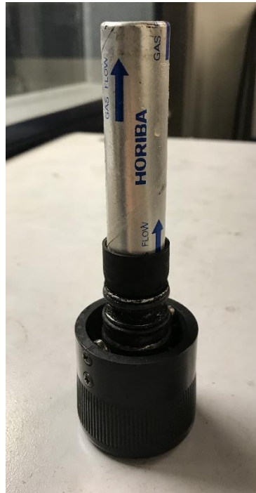
Ilustración 54. Filtro del analizador de gases de escape Horiba MEXA 7100 DEGR.
