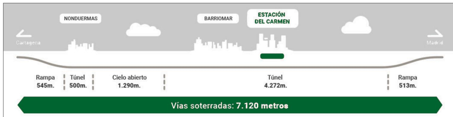
Figura 4.10. Esquema de la línea soterrada desde Nonduermas hasta Los Dolores, 7120 metros. (Fuente: Web Murcia Alta Velocidad)
