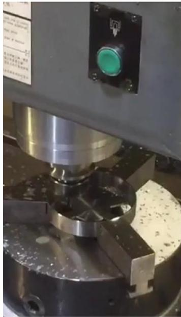
*Figura 21. Mecanizado de campana en CNC*
