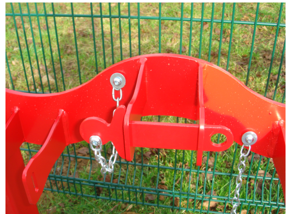
Imagen 96. Sistema de asegurado del patinete
