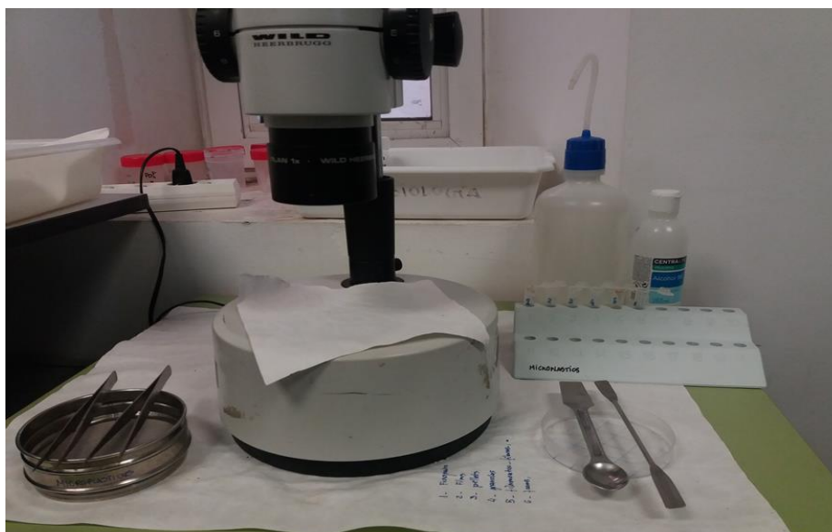
Figura 3.11: Material necesario para la identificación de los materiales plásticos.
