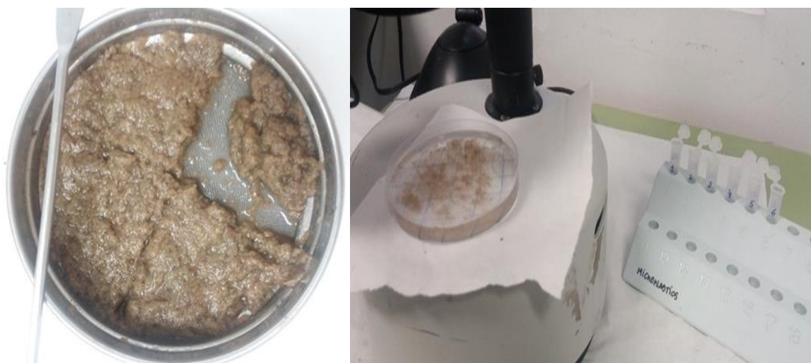
Figura 3.12: Cuarteo e identificación de la muestra del transecto Piles 2.
