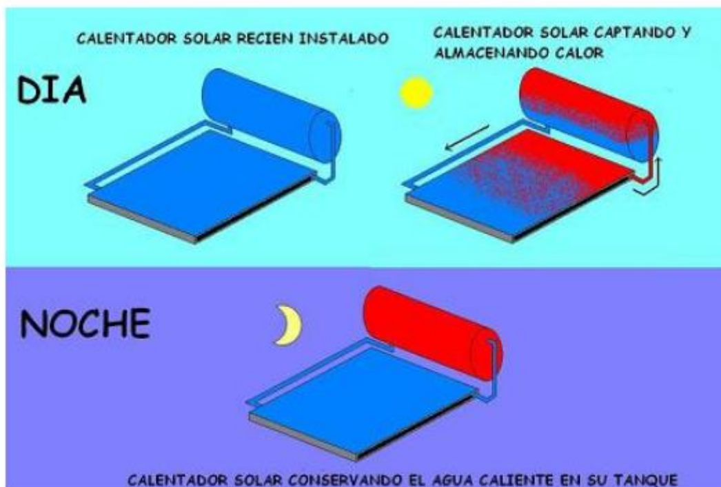
Ilustración 11: Esquema funcional de un panel térmico solar. (Fuente: Sitiosolar, 2019)
