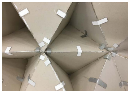
Fig. 47. Ensamblaje mediante pletinas de aluminio y adhesivo sellador. 2019.
