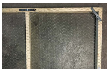
Fig. 45. Ensamblaje de la rejilla metálica sobre el bastidor. 2019.
