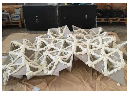
Fig. 49. Unión de los módulos y sellado de todas las juntas con poliuretano. 2019.
