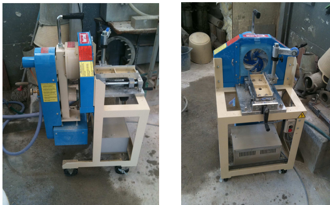
Fig. 3.5 Refrentado de probeta cilíndrica
