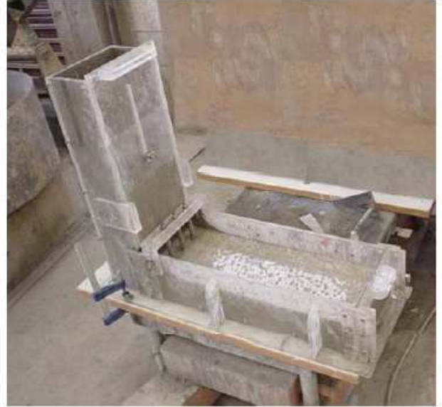
Fig. 2.12 Dimensiones de la caja L y ensayo realizado
