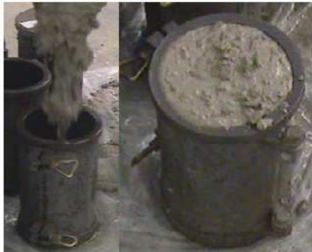
Fig 3.4 Llenado de probeta con HAC
