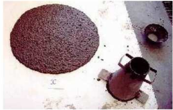
Fig. 2.7 Dimensiones del Cono de Abrams y realización del ensayo
