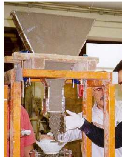
Fig. 2.11 Ensayo del embudo V. Dimensiones en mm
