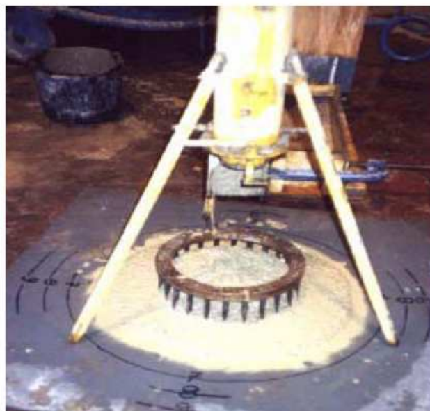
Fig 2.9 Ensayo Orimet con anillo J
