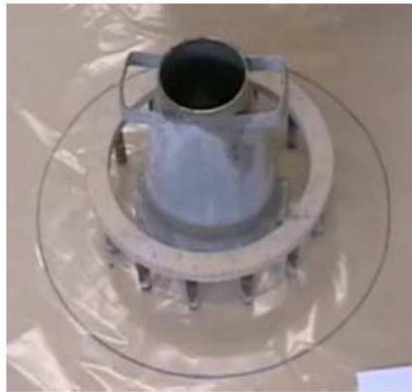
Fig. 2.8 Ensayo de Escurrimiento con anillo J
