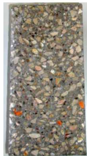
Fig. 2.19 Probeta sin segregación
