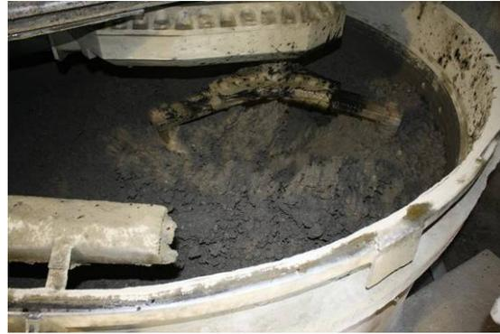
Fig.16 Amasado después de adicionar los NTC
