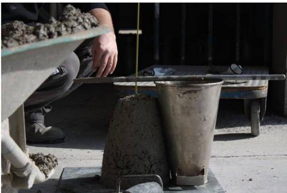
Fig.11 Medida de consistencia con cono de Abrams
