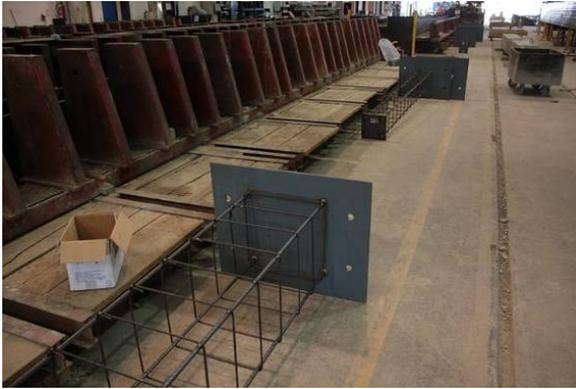
Fig.9 Armadura de pilar con basa de anclaje
