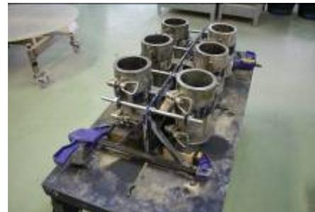
Se preparó una primera tanda de probetas (6) que se vibraron según el procedimiento descrito, y mas tarde, otra tanda de 3 probetas colocadas a tresbolillo. En esta tanda de probetas se colocaron otros 3 recipientes llenos con hormigón de la misma calidad ya fraguado, para compensar los pesos de la mesa e intentar que las 9 probetas tuviesen la misma calidad de vibrado.
