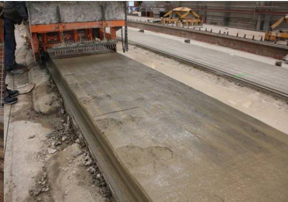
Fig.18 Ejecución de losa alveolar con hormigón de NTC
