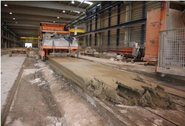
Fig.17 Ejecución de losa alveolar con hormigón de control
