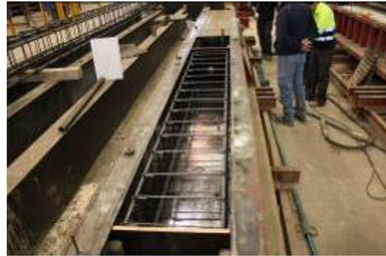
Figura. 8 Armadura del pilar prefabricado con NTCs
