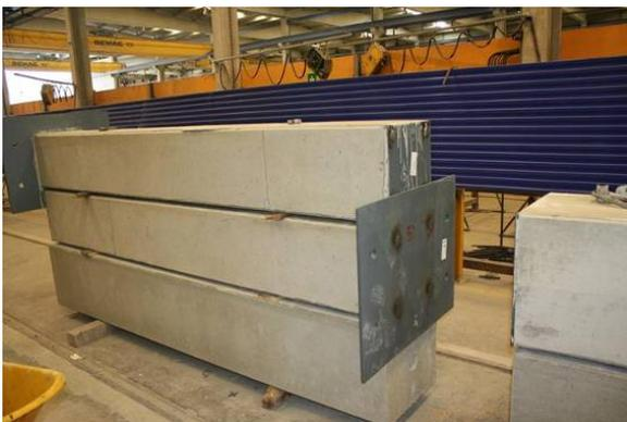
Fig.13 Pilares prefabricados ya ejecutados
