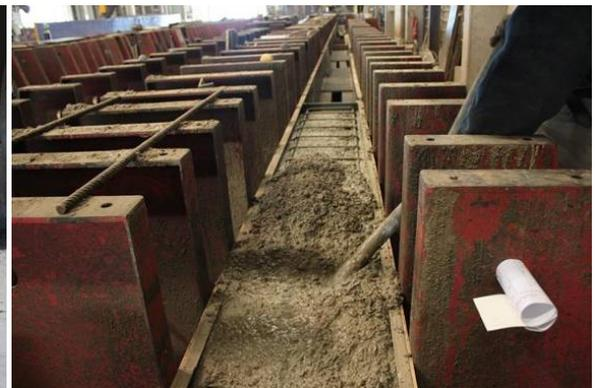
Fig.12 Vibrado del hormigón ya colocado
