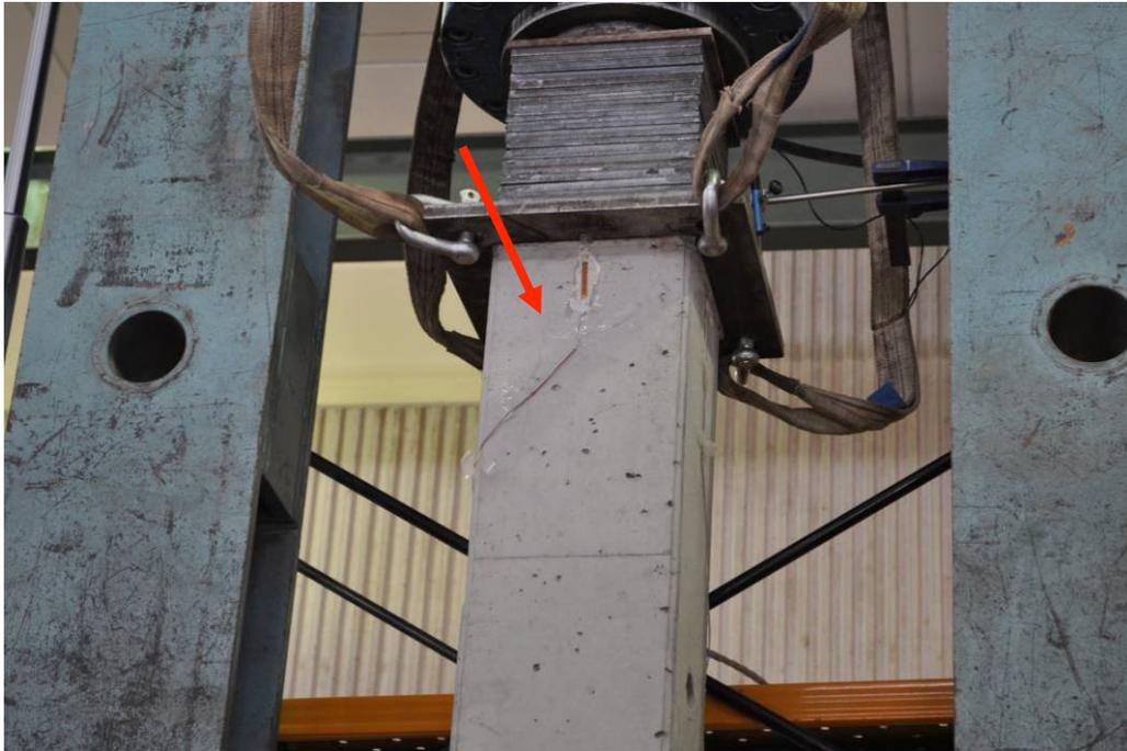
Fotografía 6, Fisuración vertical en extremo superior por concentración de tensiones observada en rotura
