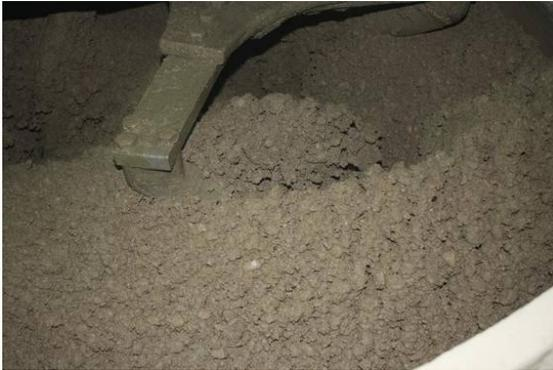
Fig.15 Amasado antes de adicionar los NTC
