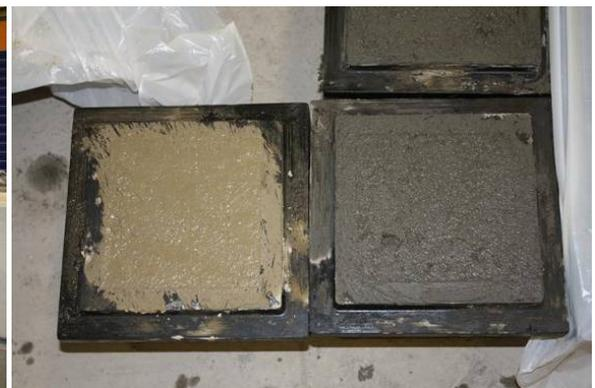
Fig.14. Probetas cúbicas de hormigón de control y con nanotubos de carbono
