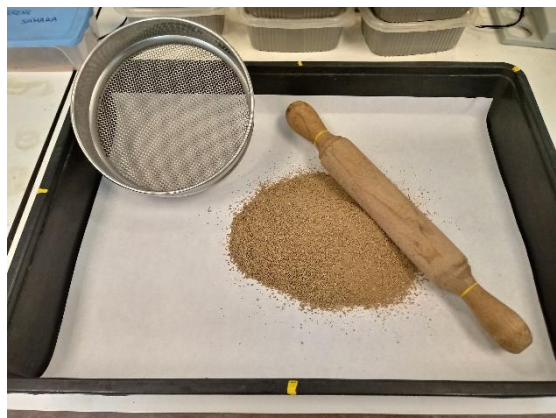
Figura 18. Preparació de les mostres de sòl. Font: Elaboració pròpia
