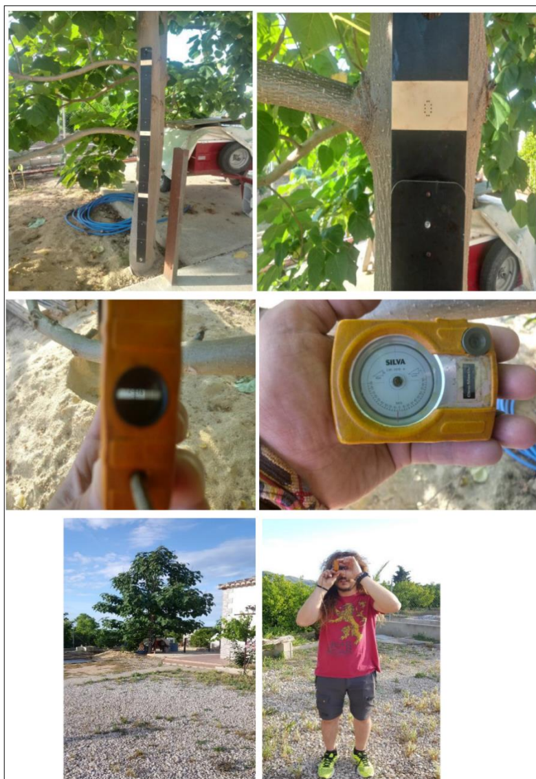
Figura 37. Càlcul de l'altura dels arbres, emprant l'hipsòmetre. Font: Elaboració pròpia
