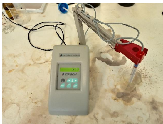
Figura 21. Anàlisi de la CE amb el conductímetre "Conductimeter Basic 30, de Crison". Font: Elaboració pròpia
