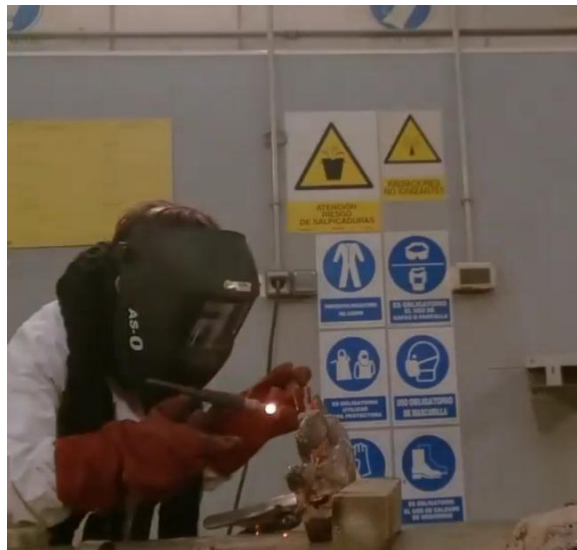
Fig. 26. Soldadura de los apéndices que sostienen la pieza a la base
