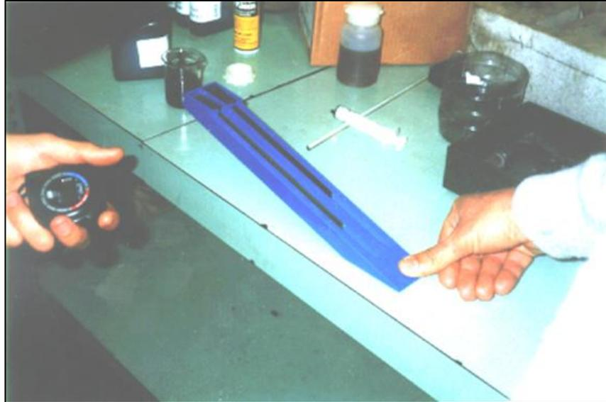
Figura 7-3 Medición cualitativa de la viscosidad por el método rampa.
