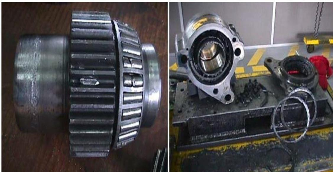
Figura 8-4 Componentes internos dañados de perforadora.
