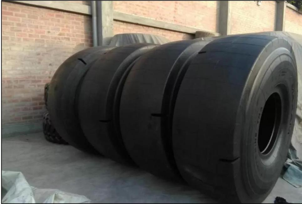
Figura 7-7 Neumático de un cargador frontal de bajo perfil (scooptram)
