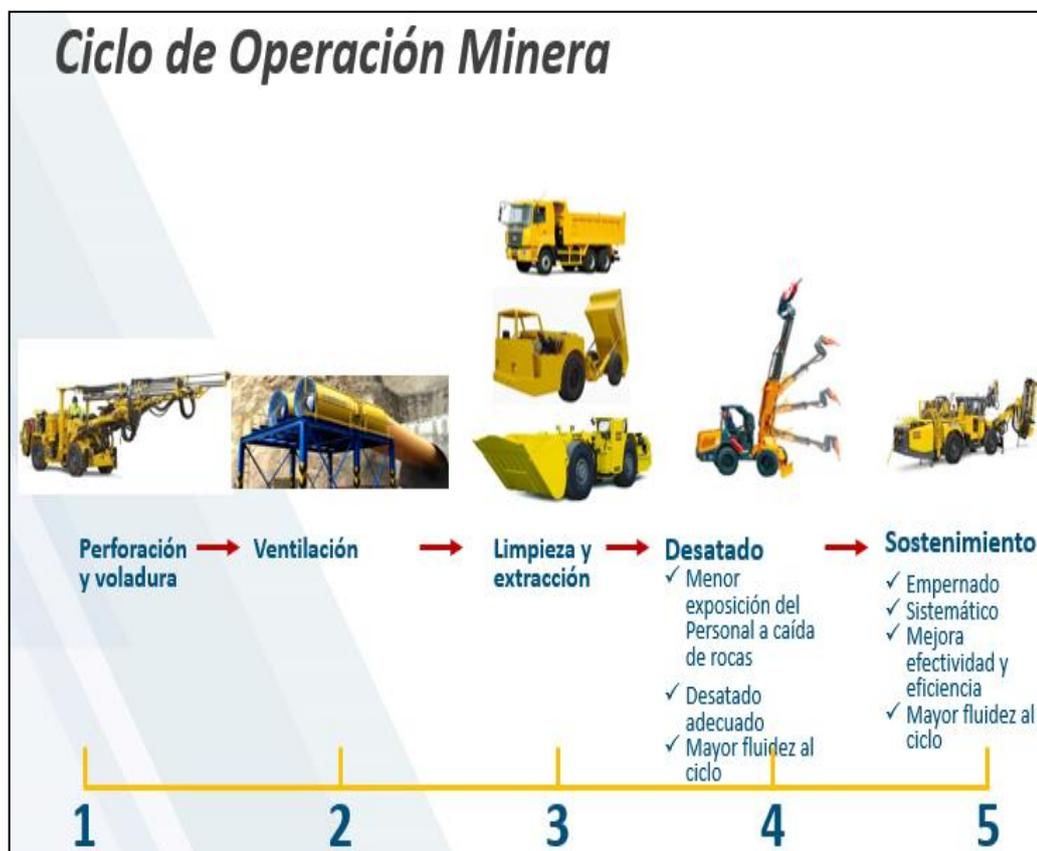
Figura 2-8 Ciclo de operación de una unidad minera subterránea.
