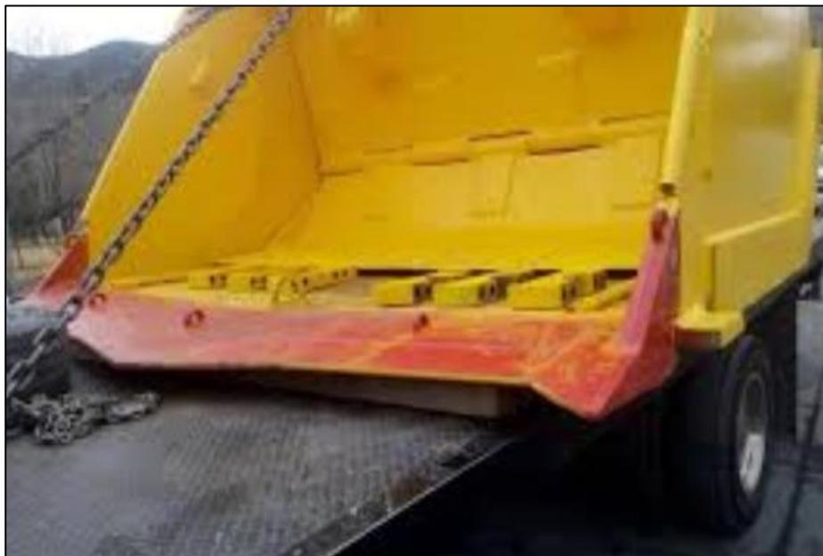
Figura 7-8 Elementos de corte de una cuchara de un cargador de bajo perfil (scooptram).
