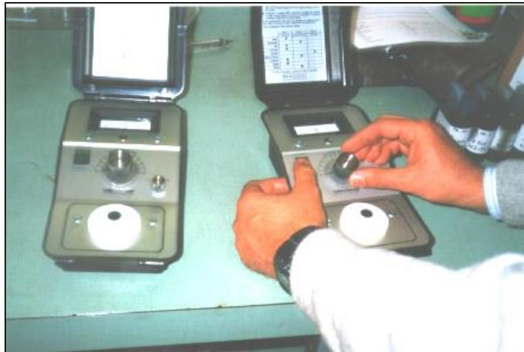
Figura 7-4 Lubrisensor para medir la conductividad eléctrica del aceite.
