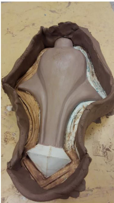
Figura 36. Elemento del hacha en el momento de sacar el molde. Alba Ríaza Tomás, 2019.
