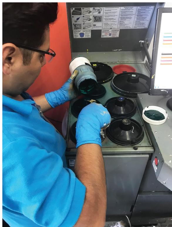
**Fig. 46:** Maquinaria Monto para la preparación a pedido de la pintura
