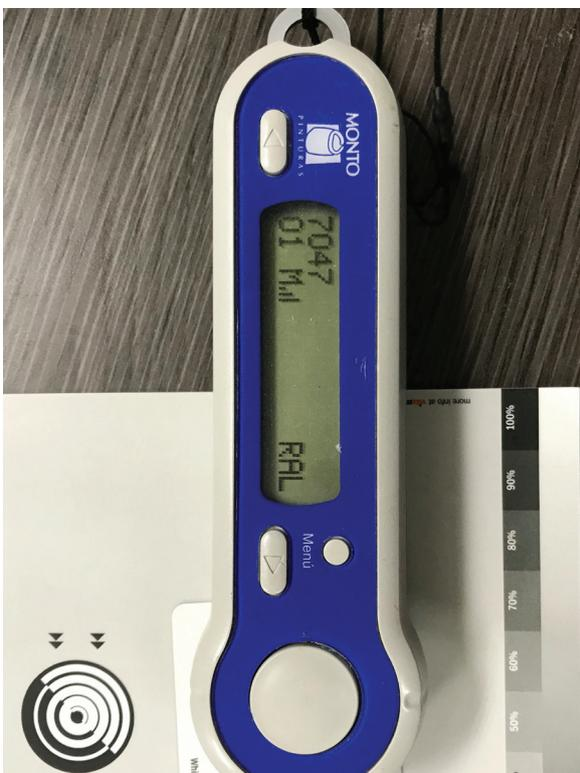
**Fig. 45:** Colorímetro empleado en la preparación de la pintura
