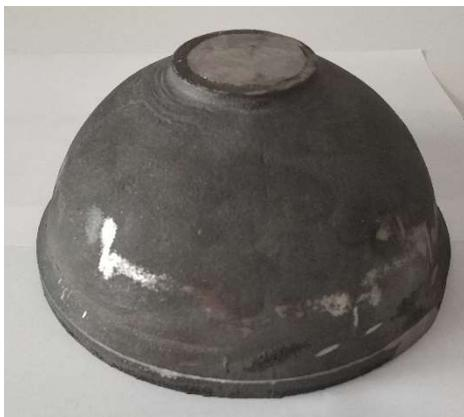
*Ilustración 62. Fundición matriz inferior B*
