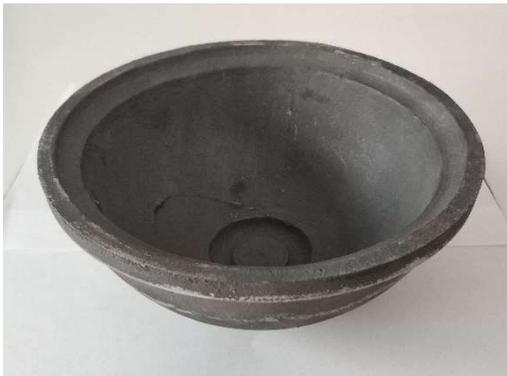
*Ilustración 60. Fundición matriz inferior A*
