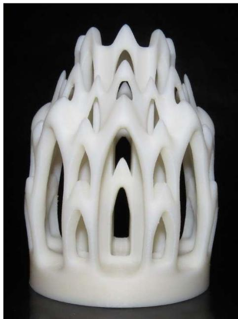
*Ilustración 48. Pieza impresa en HIPS*
