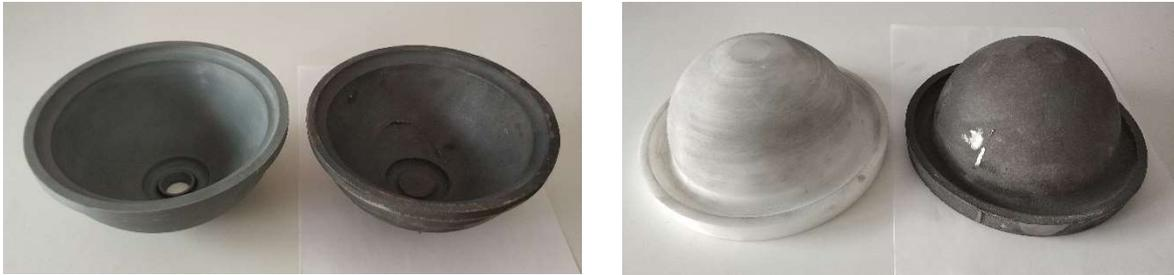
Ilustración 64. Comparación del modelo impreso 3D y el fundido de ambas matrices
