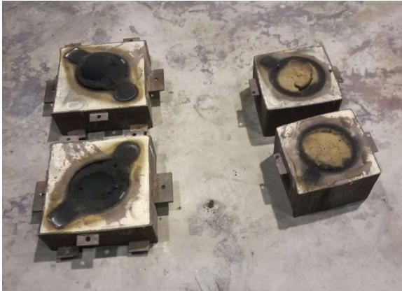
*Ilustración 58. Moldes abiertos*
