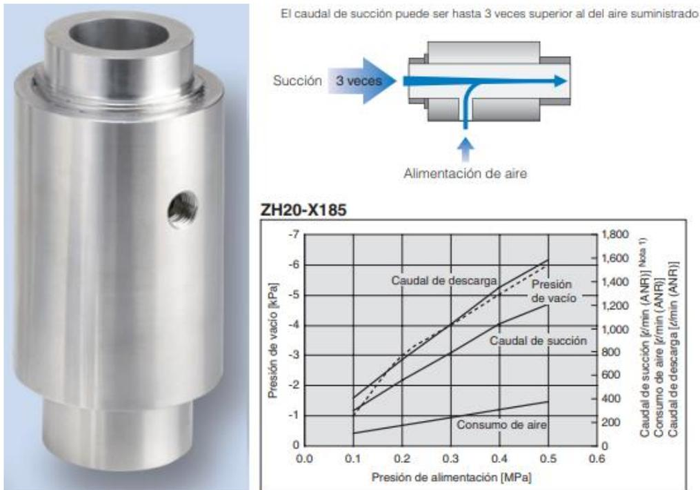
**Figura 11.** Dispositivo de aspiración; curva característica.
