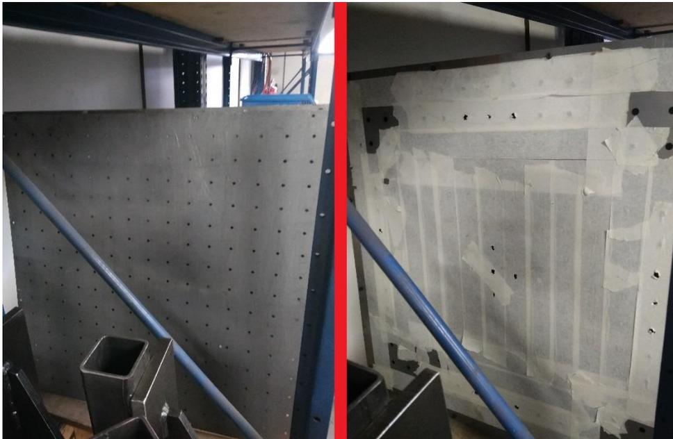
**Figura 10.** Planchas perforadas intercambiables.
