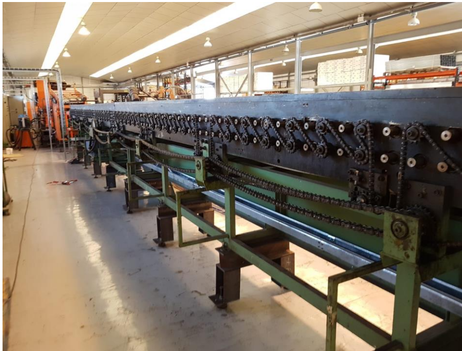
Ilustración 13 Transporte doble cinta "fuente: elaboración propia"
