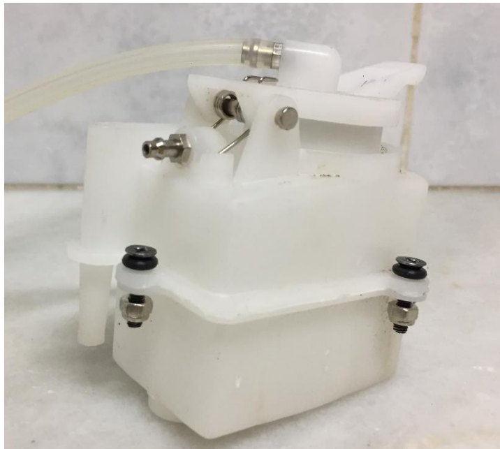
Figura14: Depósito de gasolina
