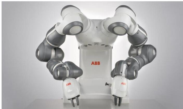
*Ilustración 8. Robot colaborativo YUMI (ABB)*
