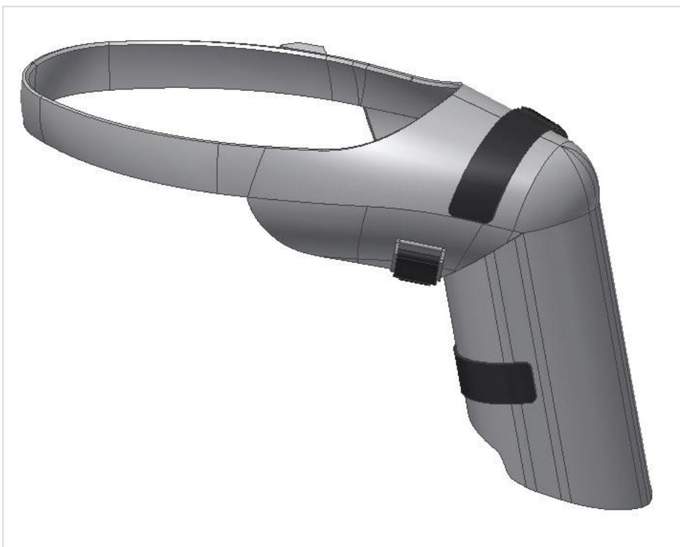
Figura 60: Modelado Cad 3D del Diseño Final de la Órtesis
