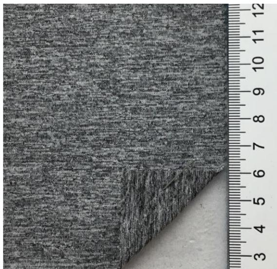
Figura 52: QL-018400 Forro Exterior Poliéster + PU
