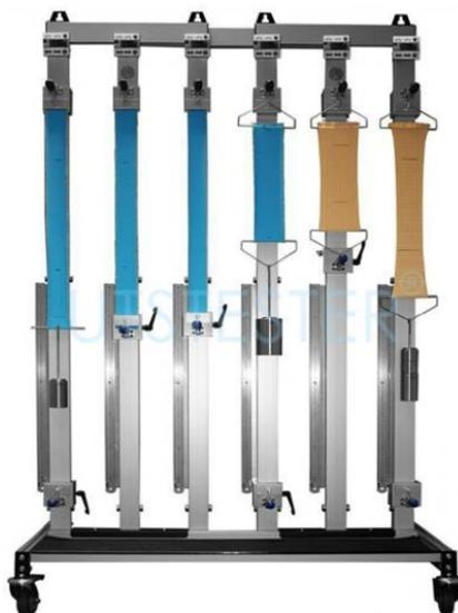
**Figura 58: Ensayos de elongación y tensión de materiales elásticos**
