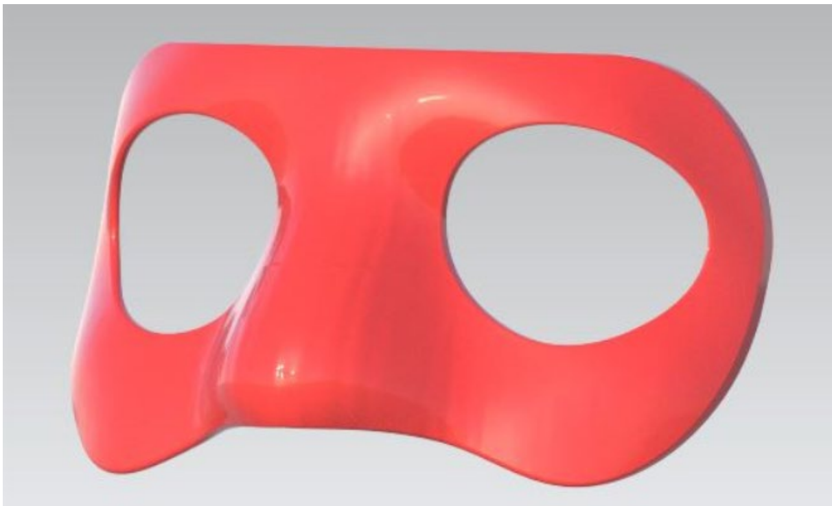
Figura 3 15. Resultado máscara medio rostro. Observar rugosidad en el contorno de la nariz.
