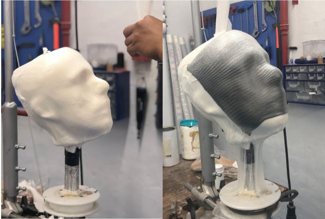
Figura 1 15. Fabricación en capas. Imagen izquierda, aplicación de PVA. Imagen derecha, aplicación policarbonato.
