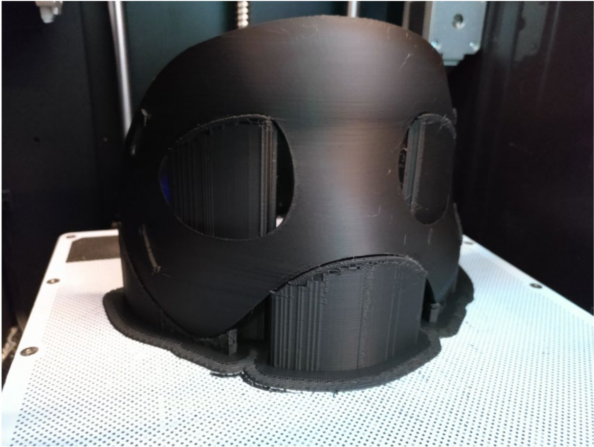
Figura 2 16.B. Máscara impresa. Con soportes.
