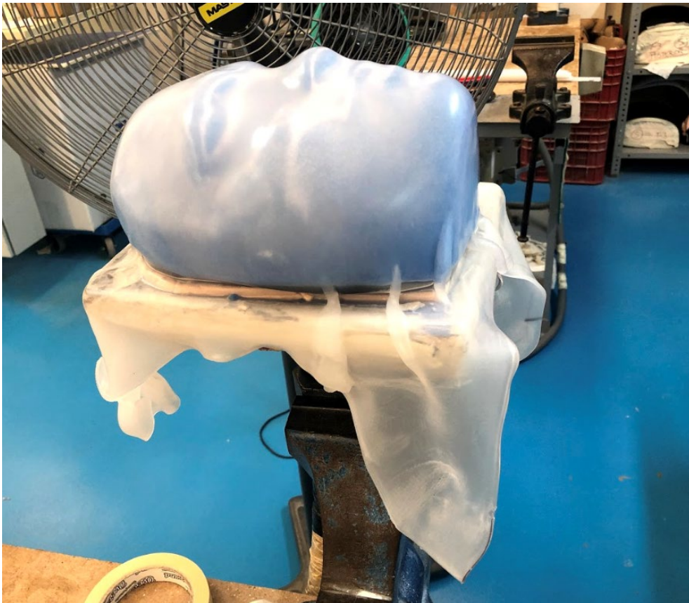
Figura 1 14. Enfriamiento de termoplástico sobre el molde posterior a la succión por vacío.
