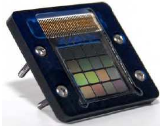
Fig. 21 SPMARRAY3035G16 de Sensl
