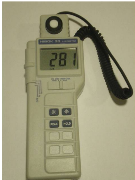
Fig 98: Aparato utilizado para medir luxes.
