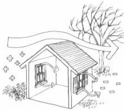
Fig 97: Ventilación cruzada fachadas este-oeste.
