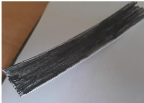
*Ilustración 26: Sensor de posición, traza de grafito.*
