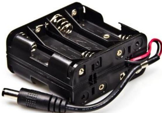
*Ilustración 28: Portapilas 12V DC*
