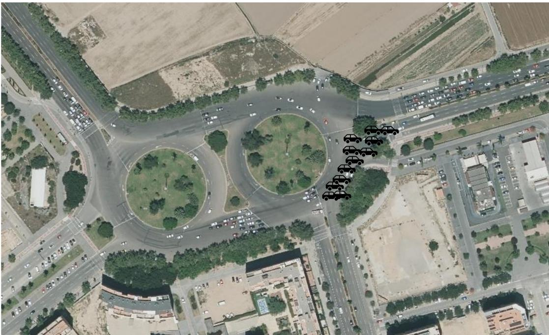
Ilustración 20: Representación del estacionamiento de vehículos que no son capaces de pasar en verde. (Fuente: elaboración propia)
