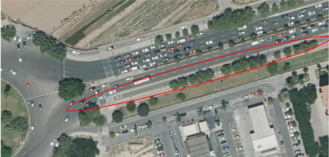
*Ilustración 22: Existencia de mediana separadora y carril bus-taxi. (Fuente: IDEE GVA).*
