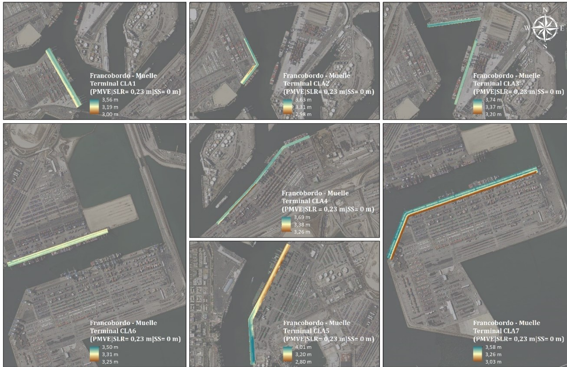
Figura 81 - Francobordo de seguridad en condiciones permanentes para el escenario 1 en los muelles de las terminales de contenedores del Puerto de Los Ángeles (Plano IV.2.1.1 en la sección de Anejos)
