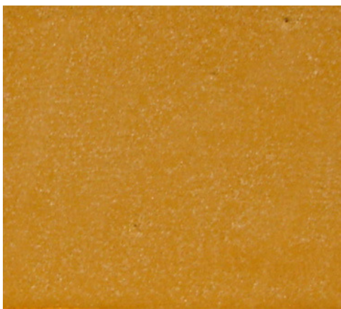
21. Mástic con sílice coloidal a pistola sobre tabla
