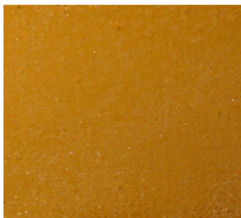
4. Mastic con carbonato cálcico a pistola sobre lienzo
