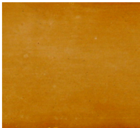
16. Mastic con sílice coloidal a muñequilla sobre tabla
