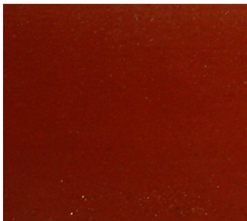
15. Mastic con sílice coloidal a muñequilla sobre tabla
