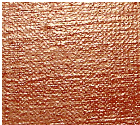
1. Mastic con carbonato cálcico a pincel sobre lienzo
