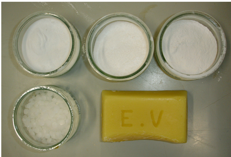
Fot. 2. de derecha a izquierda y de arriba abajo: sílice coloidal, sílice microcristalina, carbonato de calcio, cera microcristalina y cera de abeja.
