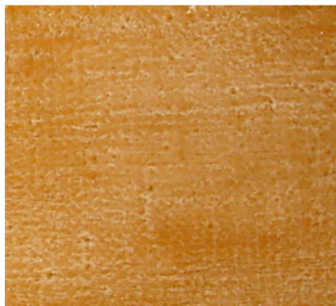
2. Mastic con carbonato cálcico a pincel sobre lienzo
