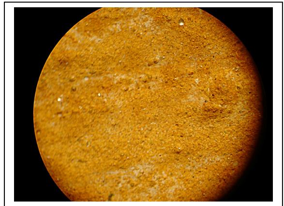
50. Dammar con carbonato cálcico a pincel
