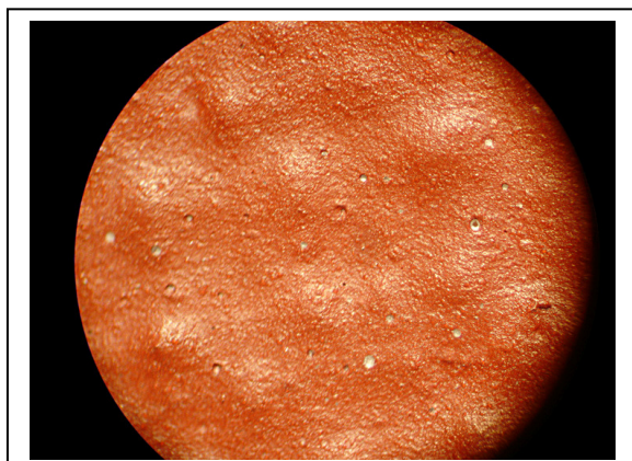
43. Dammar con sílice coloidal a pincel
