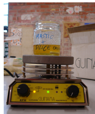
Fot. 5. Barniz de sílice durante el proceso de agitación eléctrica.
