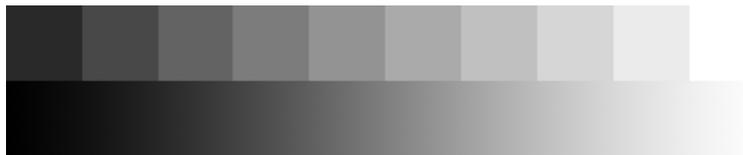
Fig. 7. Comparación entre diez pixeles, cada uno con un tono o nivel diferente (arriba) y una barra de tono continuo (abajo).
