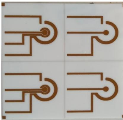
Figura 14. Resultado después de depositar y curar la capa de oro.
