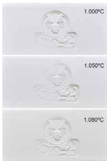
Fig.22 Aspecto de el barro utilizado, cocido a diferentes temperaturas.
