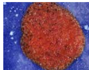
Fig.32 Prueba 4 de superposición de esmaltes. Fig.33 Detalle lila opaco sobre azul. Fig.34 Detalle amarillo opaco sobre azul. Fig.35 Detalle rojo translucido sobre azul. Fig.36 Detalle verde opaco sobre azul.
