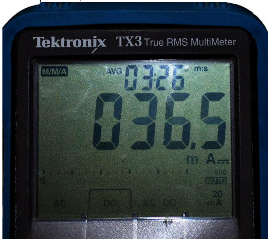
Imatge 1.3.6.1 Consum mitjà en el moment d'engegada amb el mòdul GSM actiu
