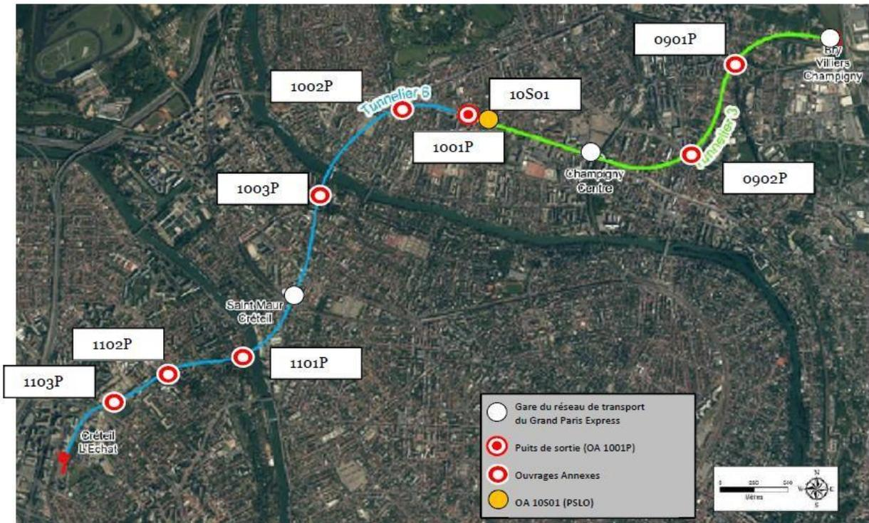
Figure 5. Synoptique des tunneliers pour le lot T2B.
