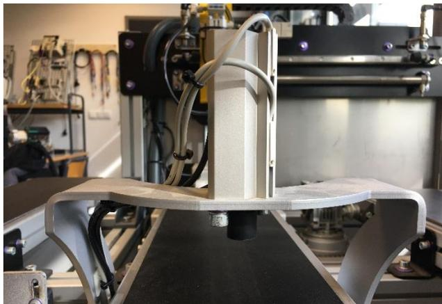
*Imagen 7. Estación de prensado de la cinta central.*
