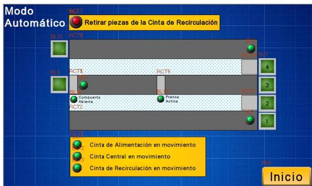
Imagen 45. Pantalla modo automático SCADA.
