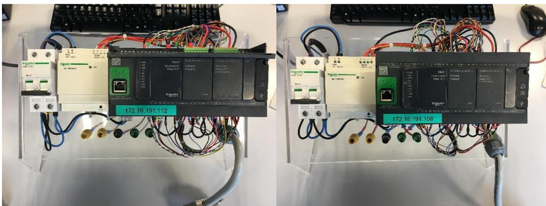
*Imagen 1. Autómatas Schneider Electric Modicon M241.*
