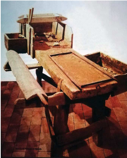
Ilustración 49. Mesa de obrador del tejero. Fuente: Revista Aunia nº14. 2006. p.32. https:// Issuu.com
