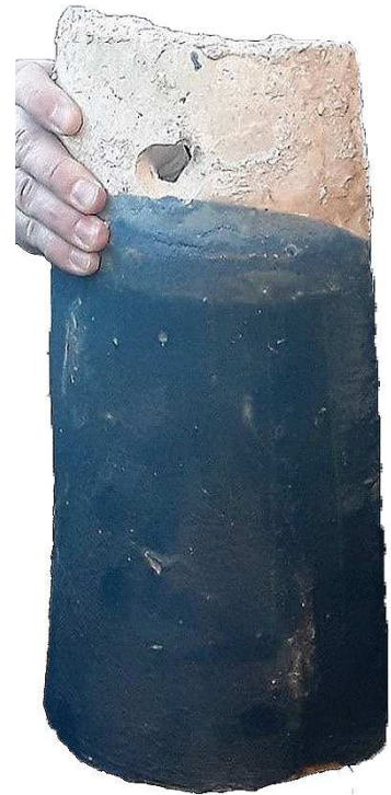
Ilustración 77. Teja recuperada con orificio para fijación mecánica. Escuelas Pías. Valencia. Fuente: Propia.
