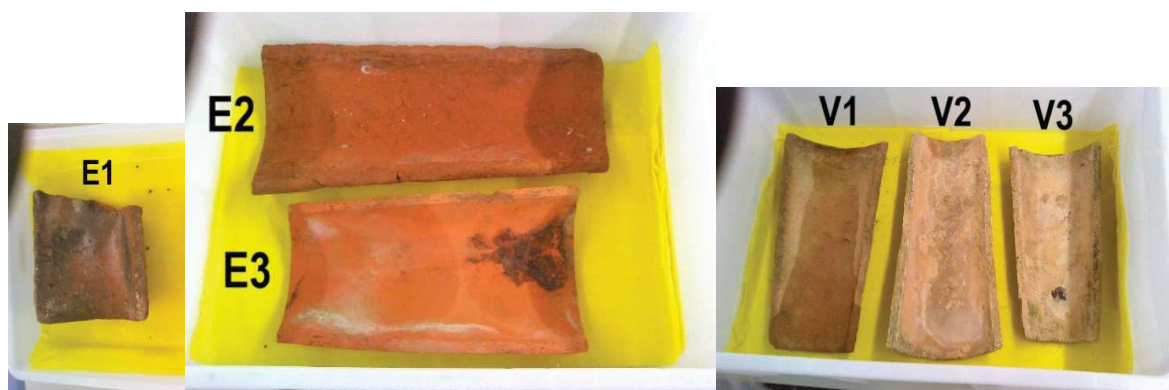
Ilustración 124. Tejas en el ensayo de capilaridad. Tiempo transcurrido de E: 24h, V: 60min. Fuente: Propia
