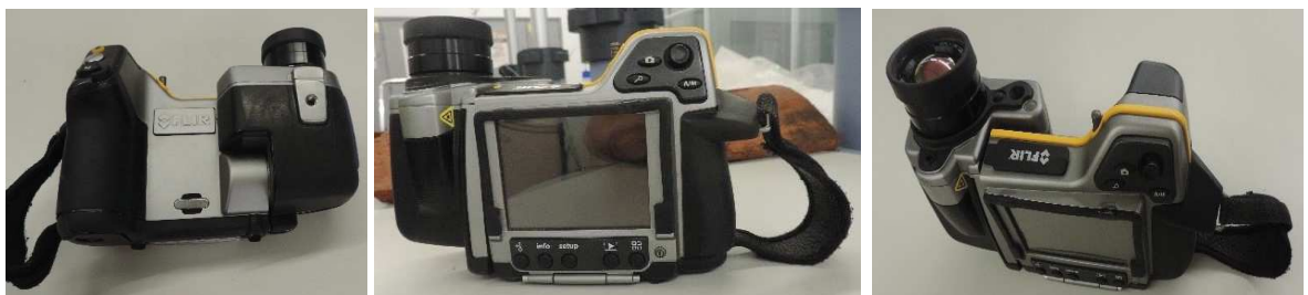
Ilustración 119. Cámara termografica con la que se hace el seguimiento de los ensayos a las tejas. Fuente: Propia
