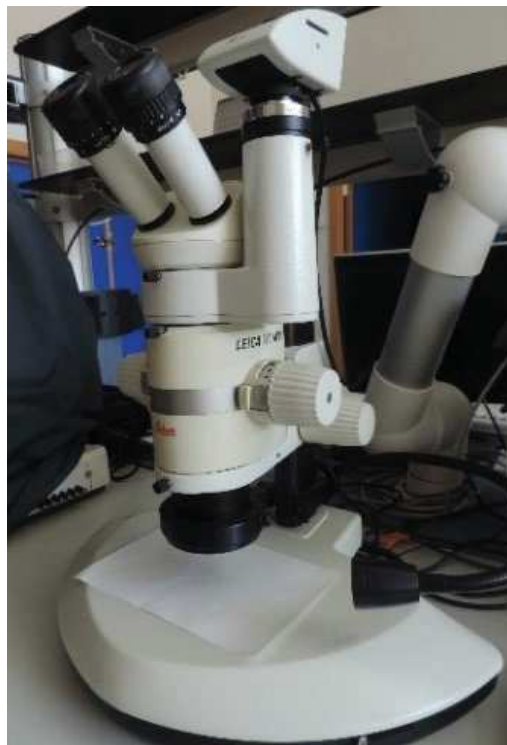
Ilustración 128. Microscopio óptico para ver las muestras de las tejas en aumento. Fuente: Propia
