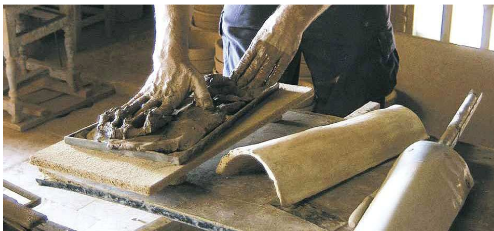
Ilustración 47. Moldeo de la teja cerámica curva. Fuente: Book Tejas Borja. p. 5
