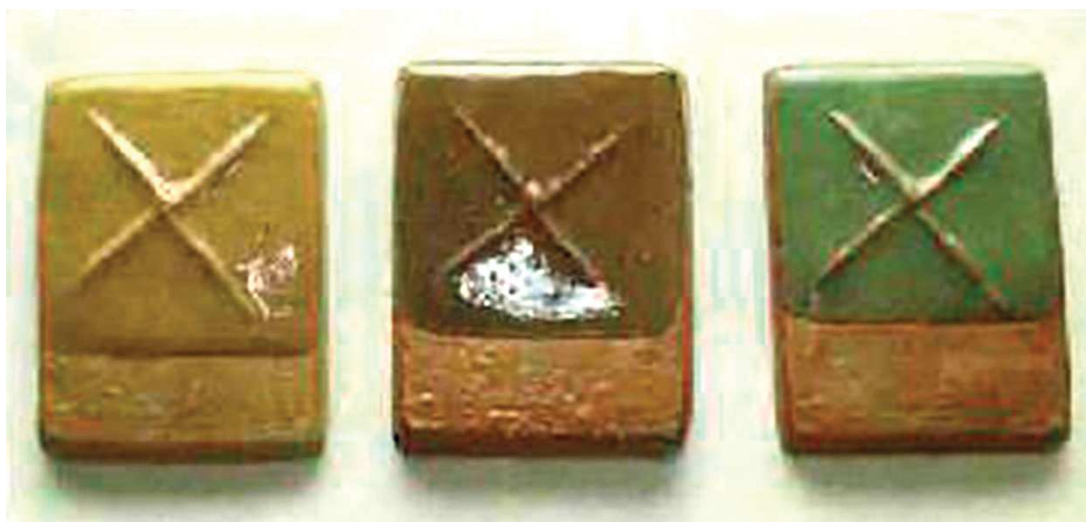
Ilustración 82. Diferencias de color según atmosfera de cocción. Fuente: Chinese glazes. https://ceramica.name
