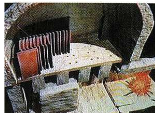
Ilustración 56. Sección y plantas de un horno cerámico. Fuente Apuntes de Máster universitario en conservación de patrimonio arquitectónico. 2018-2019.
