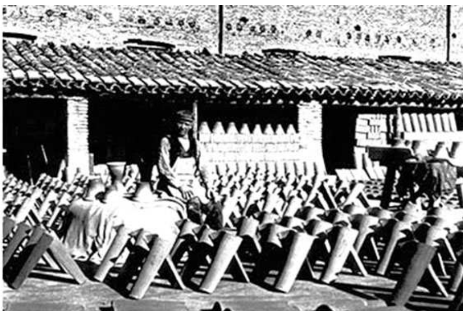
Ilustración 53. Secado en forma piramidal a pares. Teja Manual. Nicolás Viñuelas, Huesca 1920. Fuente: Banco de imágenes del grupo Uralita. en Tejas, no solo barro cocido- https://macarenaouteiral.blogspot.com
