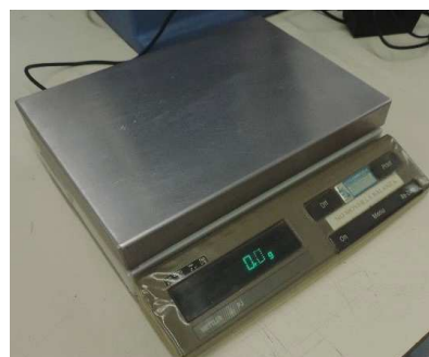
Ilustración 122. Balanza analítica utilizada en varios ensayos para pesar las tejas. Fuente: Propia
