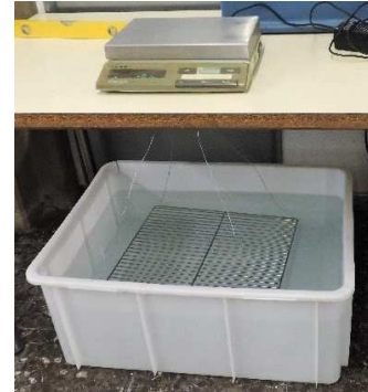
Ilustración 126. Aparatos utilizados para realizar el pesaje hidrostático de las tejas. Fuente: Propia
