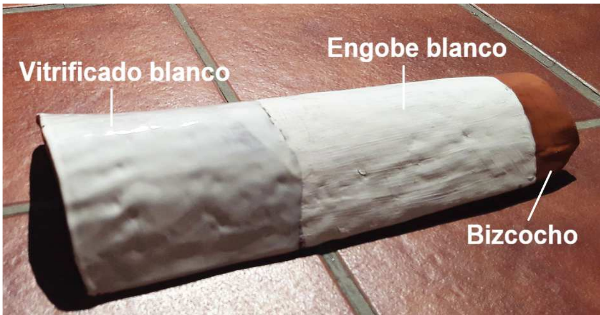
Ilustración 80. Teja curva cerámica con acabado vitrificado, engobe y bizcocho. Elaboración: Propia. Fuente: Propia.
