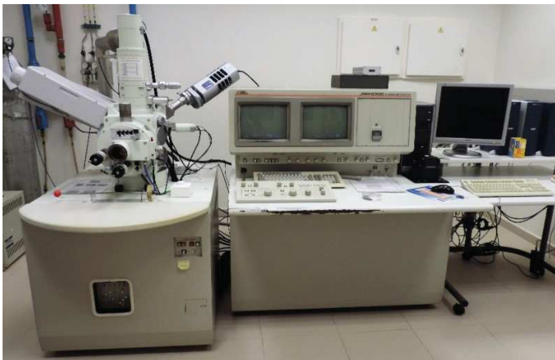
Ilustración I30. Microscopio electrónico de barrido donde se analizarán las muestras de las tejas. Fuente: Propia
