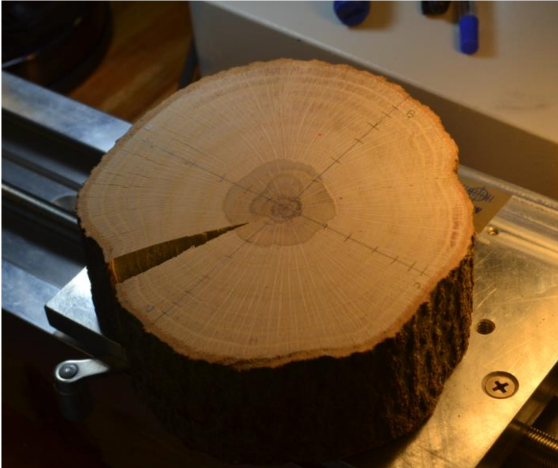
Figura 6: Detalle de una rodaja con los anillos marcados sobre cuatro radios.
