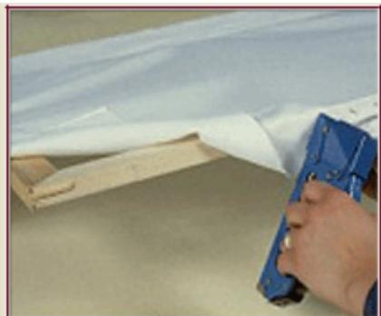
Fig. 11. Montaje tela de poliéster
