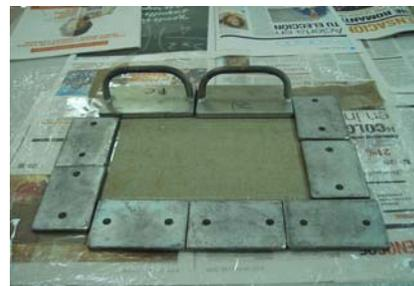
Fig.22. Aplicación de las bandas perimetrales
