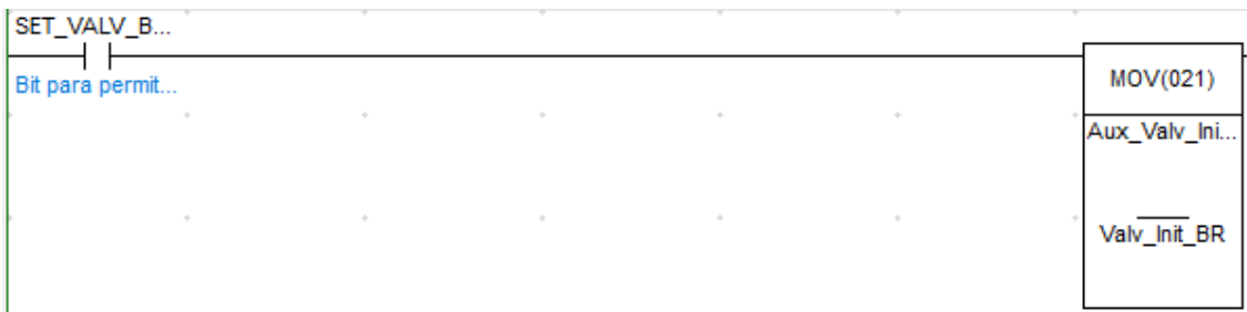
Figura 135. Línea de programa: asignación del valor de punto de funcionamiento a la variable que usa la ley de control.
