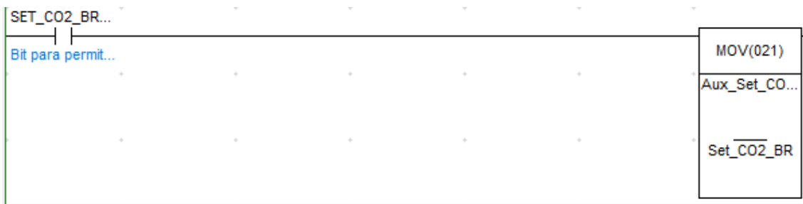
Figura 136. Línea de programa: asignación del valor de referencia a la variable que usa la ley de control.
