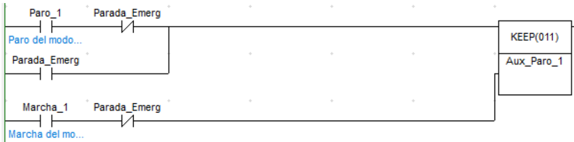
Figura 138. Línea de programa: activación de marca auxiliar de paro.
