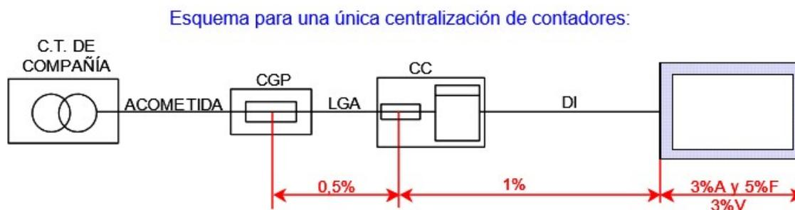
**Figura 6.** Esquema de la Instalación. Fuente: CTE-BT-19
