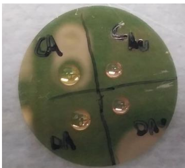
Figura 124. Disco de SiO 2 recubierto por una fina capa de oro.
