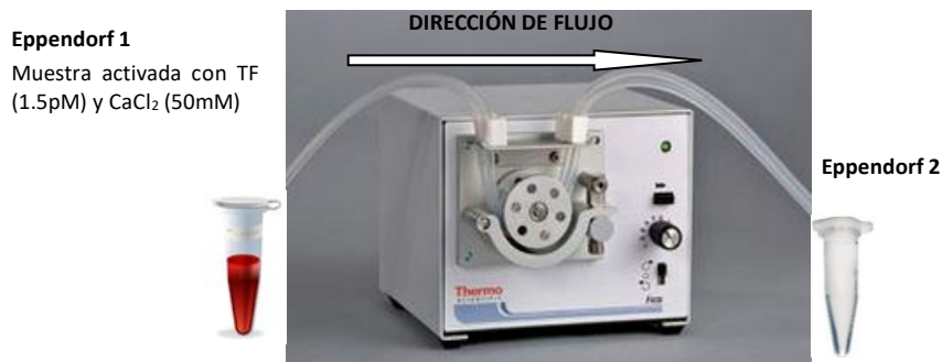
Figura 48. Esquema de la bomba peristáltica para experimento de una muestra de WB activada.
