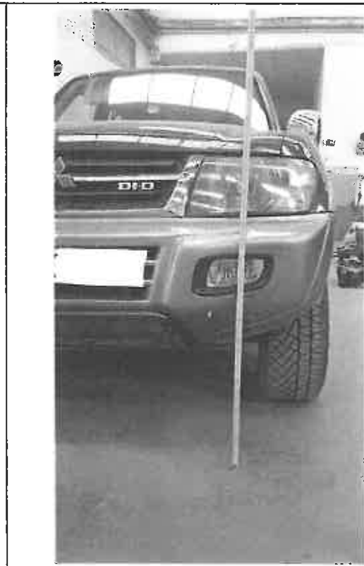
Foto 16: Detalle altura dispositivos de alumbrado
