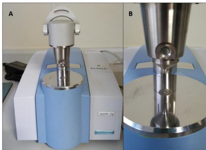
Figura 9. A) Equipo para el análisis de FT-IR B) Detalle del vástago móvil del equipo
