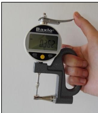
Figura VIII. Medición del espesor de la cáscara del huevo. Fuente: Elaboración propia.
