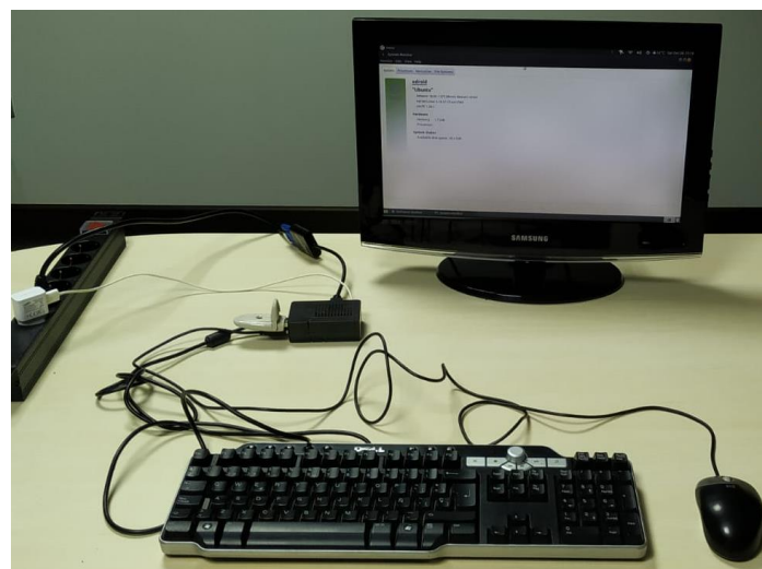
Figura 2 Montaje con la Odroid C2 para la recolección de datos
