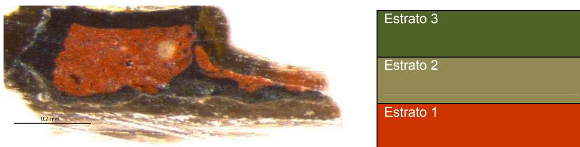
Figura 31. Microfotografía de la sección transversal de la muestra A4. Esquema de los estratos.
