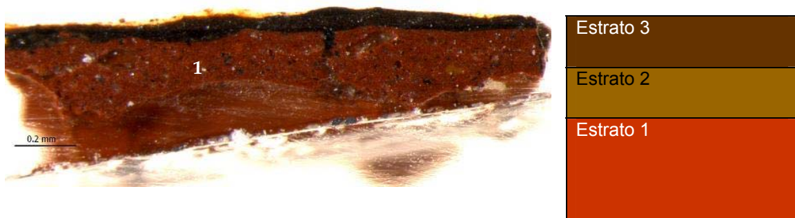
Figura 36. Microfotografía de la sección transversal de la muestra A6.
