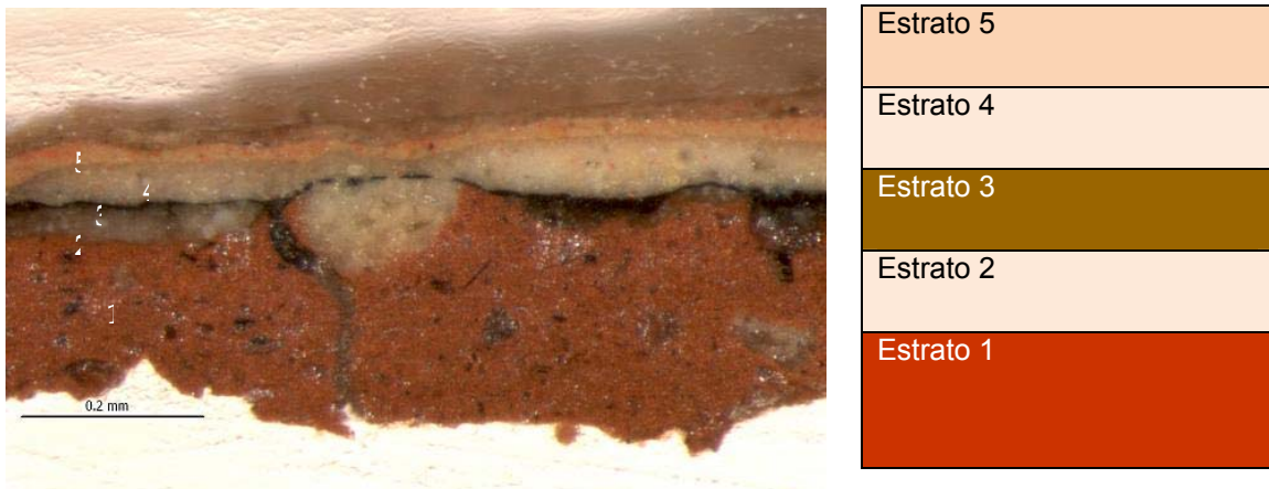
Figura 27. Microfotografía de la sección transversal de la muestra A2. Esquema de los estratos.
