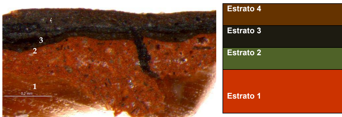
Figura 19. A) Microfotografía de la sección transversal de la muestra A1 en la que se distinguen cuatro estratos. B) Esquema de los estratos.
